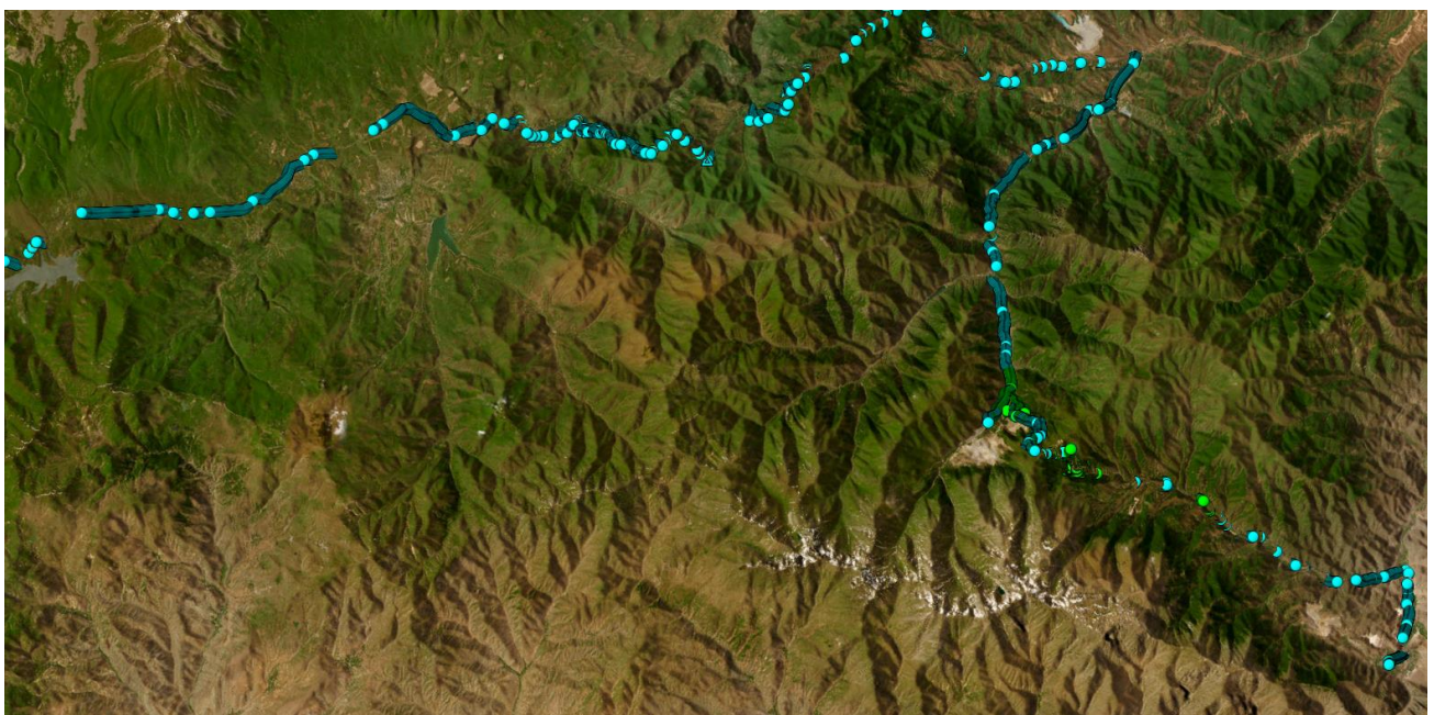
Նկար 11. ք. Մեղրիից գ. Ագարակ գնացող ճանապարհին իրականացված գամմա ճառագայթման բնական ֆոնի սկրինինգային ճառագայթային մոնիտորինգի արդյունքները
